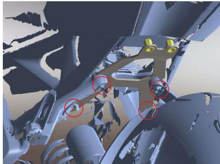
**2. Inserire la fascetta sul raccordo, installare il raccordo Spark sul catalizzatore originale e fissare la staffa.**
