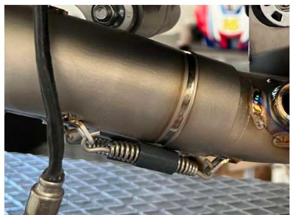
**5.1. Inserire il raccordo 2in1 e rimontare i cavi della valvola come in foto.**
