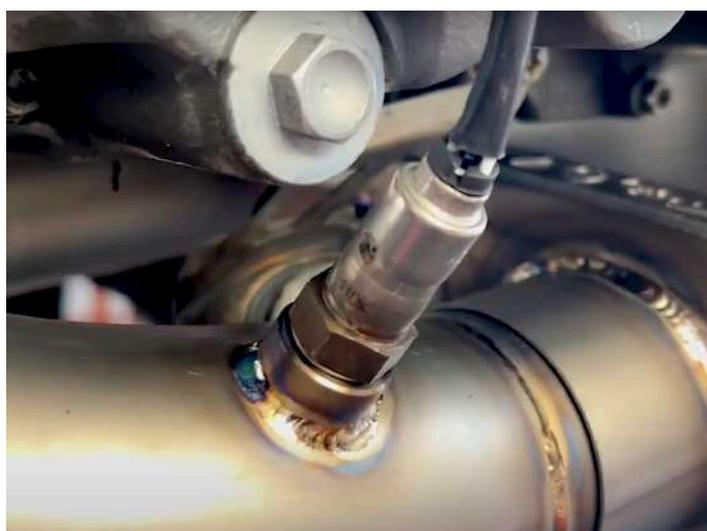
**15. Montare il silenziatore Spark (o quello originale), assicurandosi che la guarnizione in grafite sia correttamente posizionata all'interno dell'alloggiamento. Verificare l'allineamento del silenziatore con la moto, quindi serrare il bullone della staffa e la fascetta.**
