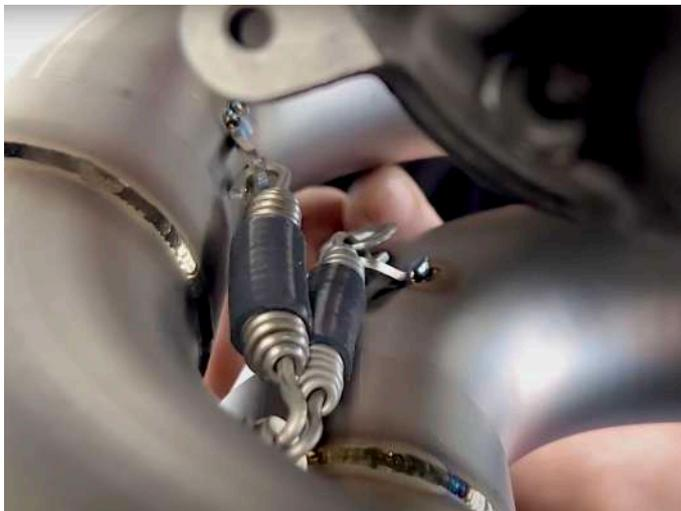
**10. Installare il box presilenziante e fissarlo al telaio utilizzando le viti originali e i dadi in dotazione. Successivamente, agganciare la molla.**
