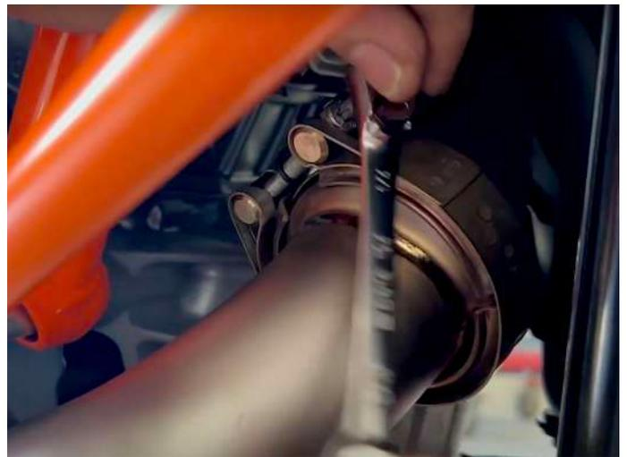
**9. Installare il collettore 2-in-1, assicurandosi che i tubi non interferiscano con altri componenti della moto.**
