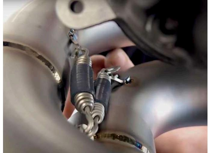
**10. Installare il box presilenzianti e fissarlo al telaio utilizzando le viti originali e i dadi in dotazione. Successivamente, agganciare la molla.**
