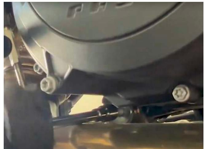
**4. Svitare le 2 viti del paracalore per rimuovere la sonda lambda.**
