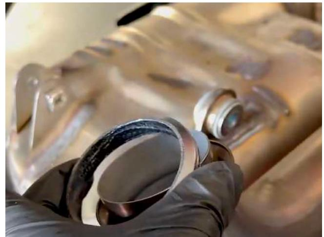
**\* Durante la rimozione, le guarnizioni potrebbero danneggiarsi, specialmente se la moto è stata sottoposta ripetutamente a temperature elevate. In tal caso, si consiglia la sostituzione con guarnizioni originali KTM (cod. 61305105005).**
