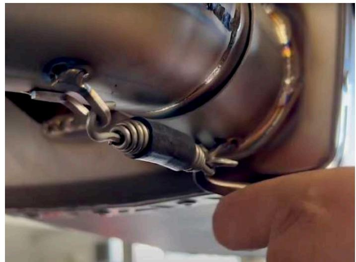
**11. Installare la sonda lambda sul raccordo 2-in-1 e serrarla.**
