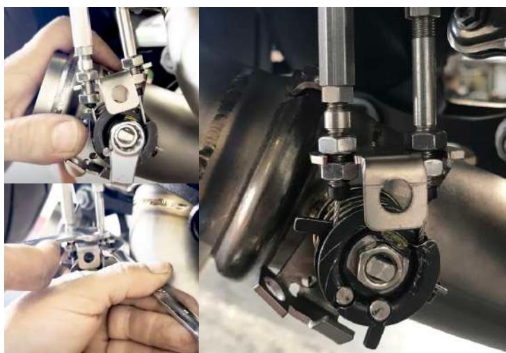
**15. Montare il silenziatore Spark (o quello originale), assicurandosi che la guarnizione in grafite sia correttamente posizionata all'interno dell'alloggiamento. Verificare l'allineamento del silenziatore con la moto, quindi serrare il bullone della staffa e la fascetta.**
