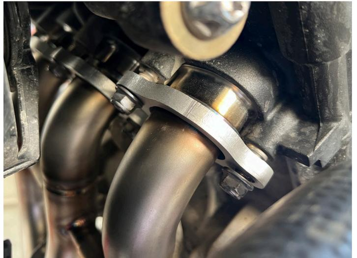
**3. Inserire il 3in1 nei cilindri verificando la distanza del catalizzatore con la coppa dell'olio.**
