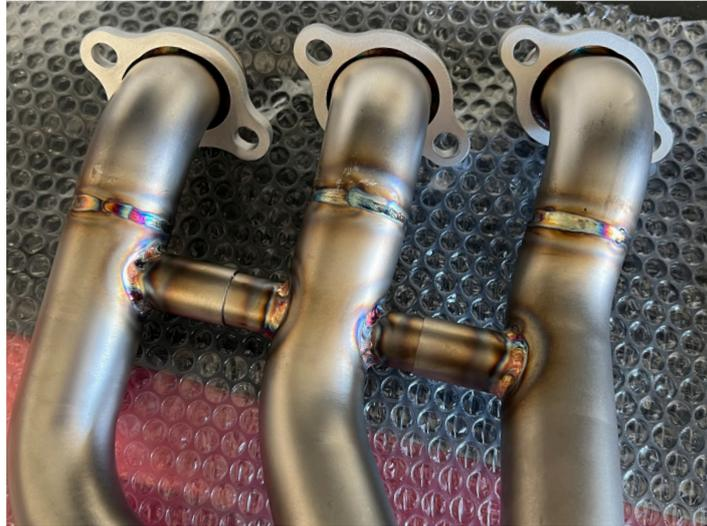
**2. Installare il collettore Spark assicurandosi prima della presenza della guarnizioni nelle bocchette dei cilindri. Fissare il collettore avvitando leggermente i bulloni originali.**
