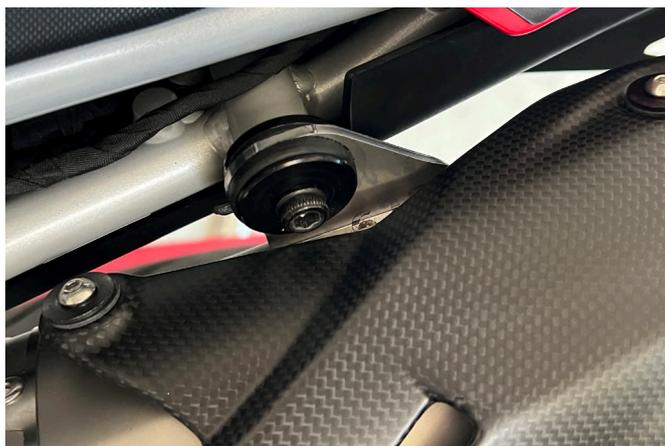
**4. Montare il paracalore originale (o compatibile con l'originale) utilizzando le viti in dotazione ed avvitandole sulle staffe premontate sui silenziatori. È possibile che le staffe siano da regolare svitando le viti presenti sul silenziatore, per adattare perfettamente il paracalore.**
