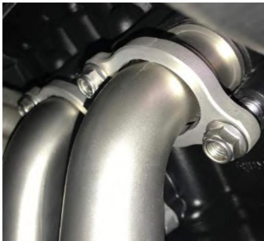
**3. Inserire sul bivio 3in1 la riduzione della sonda lambda, poi rimontare la sonda.**
