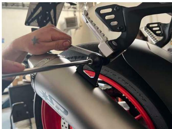
**9. Per il montaggio con staffa racing inserire i 2 distanziali tra il telaio e la staffa.**
