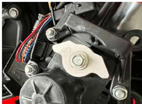
**5. Rimuovere i cavi della valvola staccando le fascette che li tengono fissati al telaio. Una volta staccate le fascette sfilare con delicatezza i cavi.**
