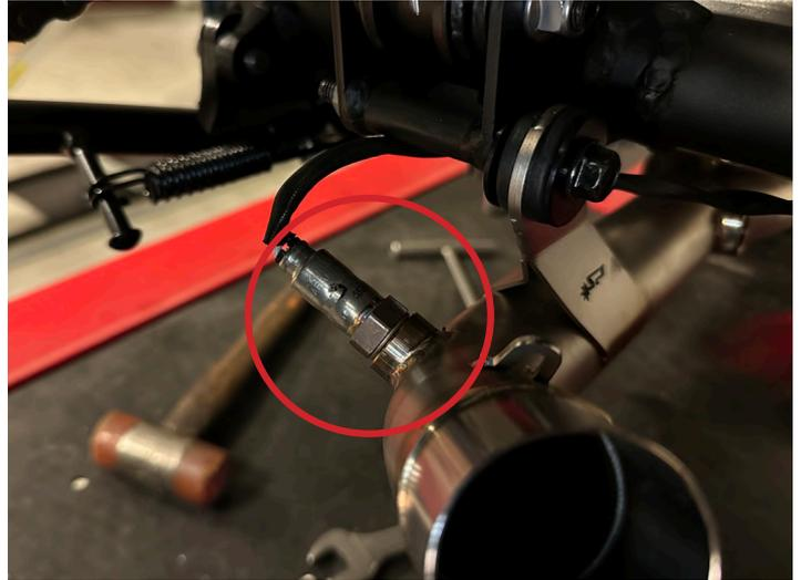
**6. Inserire il riduttore della presa della sonda lambda ed avvitarlo. Successivamente rimuovere i le fascette che fissano il filo della sonda al telaio e successivamente avvitare la sonda lambda al raccordo.**
