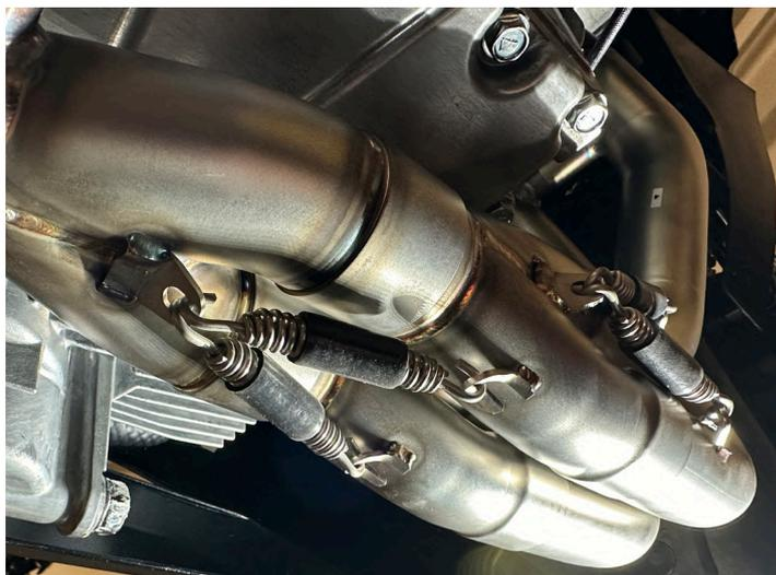
**4. Inserire il raccordo e verificare che la staffa combaci con il foro del telaio, successivamente avvitare utilizzando il dado originale.**
