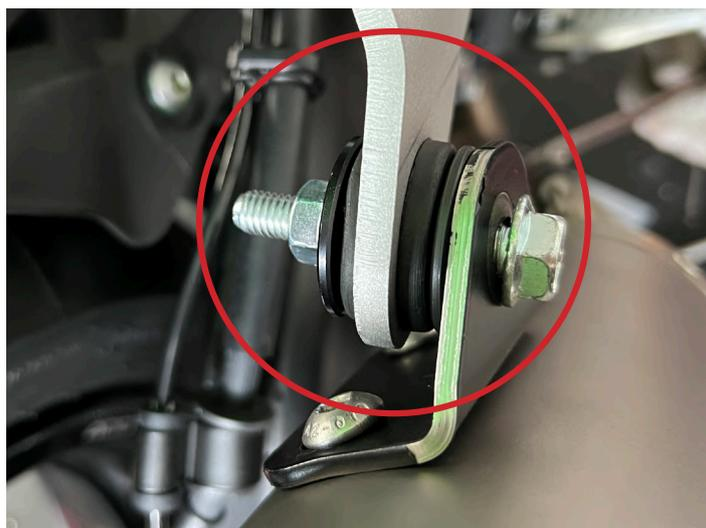
**Per installare il kit mantenendo la pedana originale si necessita di un kit minuteria optional che prevede staffa silenziatore, distanziale e vite di fissaggio.**
