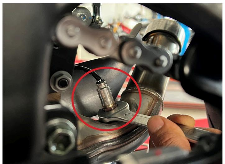
**3. Rimuovere il bullone che tiene fissato lo scarico al telaio.**
