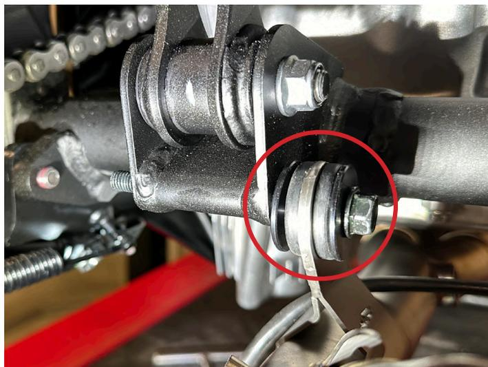
**5. Spostare passaggio del cavo della sonda lambda come in foto ed avvitarlo al raccordo. (sonda che sullo scarico originale era dopo il catalizzatore)**
