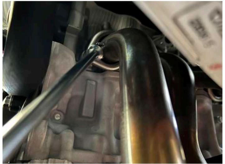
**8. Allentare la fascetta, rimuovere il bullone che tiene fissato lo scarico al telaio e rimuovere prima il box originale e successivamente i collettori**
