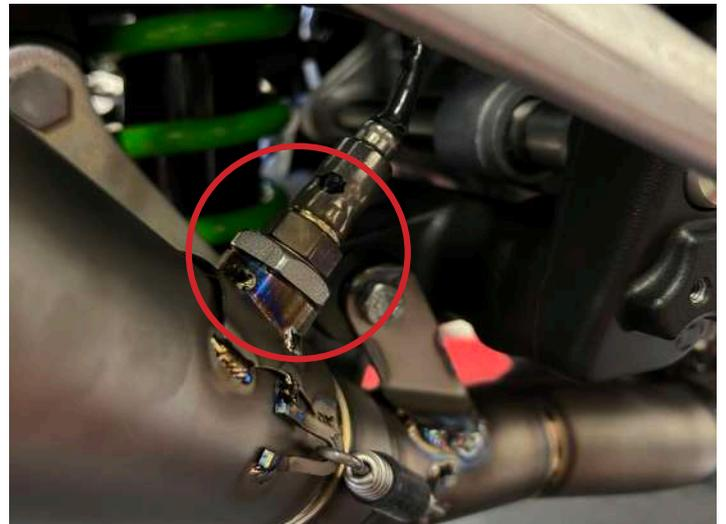
**8. Spostare passaggio del cavo della sonda lambda come in foto ed avvitarlo al raccordo. (sonda che sullo scarico originale era prima del catalizzatore - ROSSA)**
