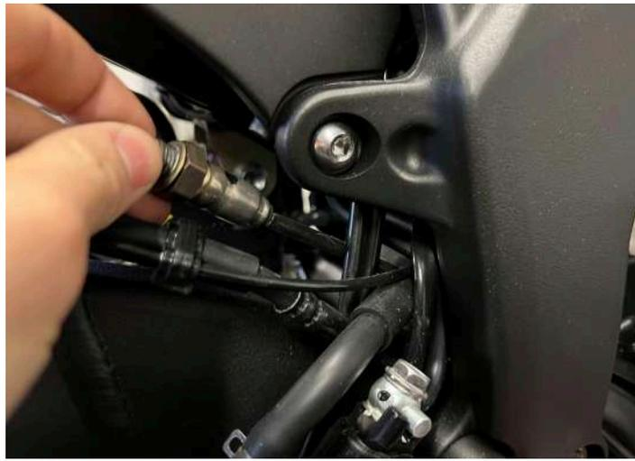
**7. Prima di avvitare la sonda lambda al raccordo avvitare il riduttore da M18 a M12 con la sua guarnizione, dopodiche avvitare la sonda al raccordo.**
