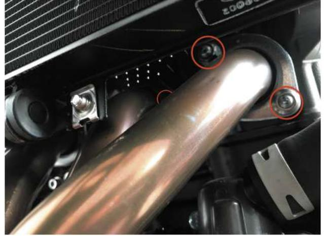
**2. Togliere la sonda lambda e le viti che sostengono il catalizzatore, poi rimuovere il kit originale.**
