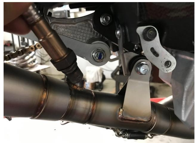
**8.Installare la staffa alla pedana usando le viti originale, poi montare il raccordo al silenziatore**
