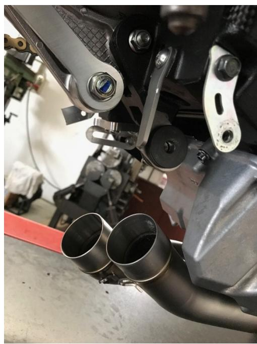
**6.Installare il bivio 2in1 fissandolo con la vite M8 e il bullone in dotazione alla staffa precedentemente montata**
