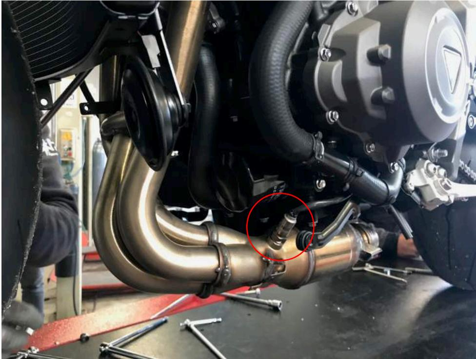
6. Rimuovere i 6 dadi che sostengono i collettori e smontarli dalla moto facendo attenzione alle guarnizioni nei cilindri che saranno da ri-utilizzare nel montaggio del collettore Spark.
