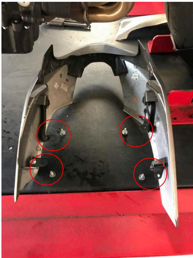
4. Rimuovere la staffa di fissaggio del radiatore
