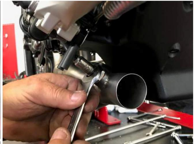
6. Montare la carena con le viti originali e rimontare il silenziatore originale oppure il silenziatore Spark acquistato separatamente.
