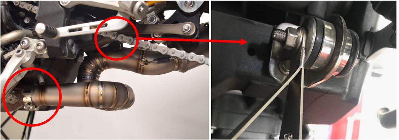
2. Montare il silenziatore Spark fissandolo alla pedana con la vite e dado originali senza stringere completamente la vite
