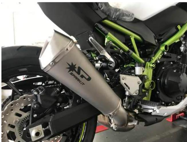
3. Fissare la staffa silenziatore al telaio utilizzando la vite originale e il dado.
