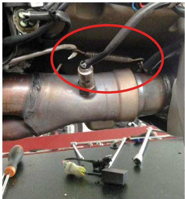
**4. Allentare i bulloni del cilindro del collettore originale per facilitare lo smontaggio del silenziatore.**
