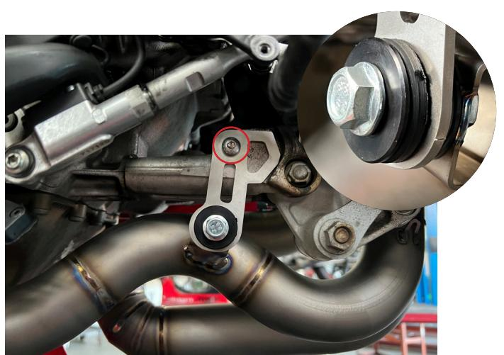
**3. Fissare la staffa dei collettori al telaio, montare il secondo collettore avvitando leggermente i bulloni utilizzando i distanziali in dotazione.**
