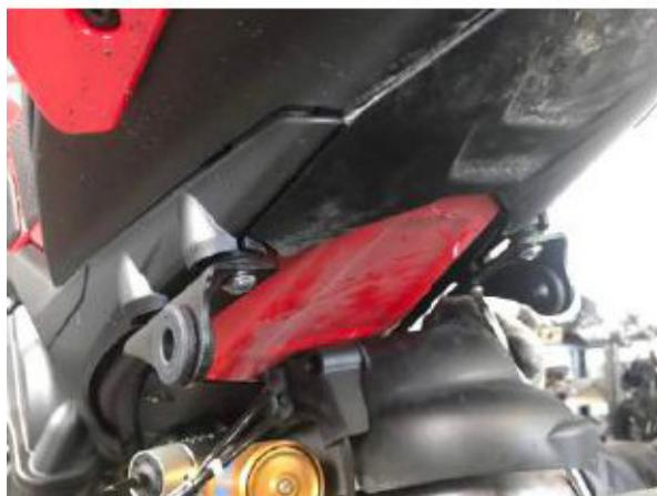
**7.Fissare da entrambi i lati della moto le staffe telaio al raccordo utilizzando vite, dado e distanziali in dotazione, tenendo all'interno le staffe del raccordo.**
