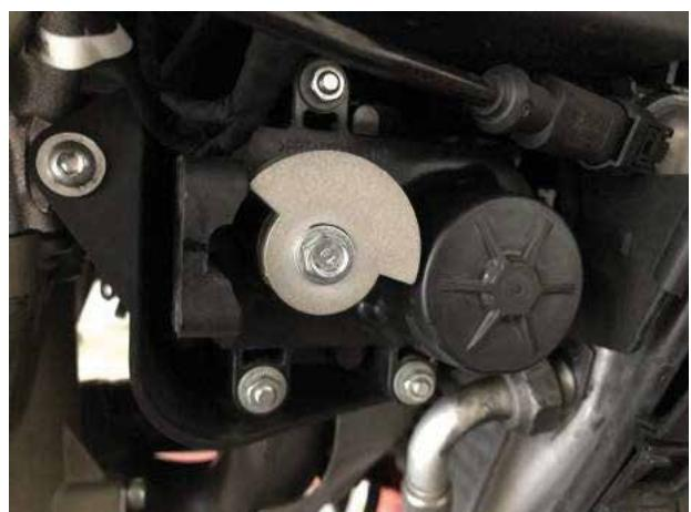
**2. Montare il primo collettore usando le molle originali, fissare la staffa al telaio come in foto ed avvitare leggermente il bullone utilizzando i distanziali in dotazione.**
