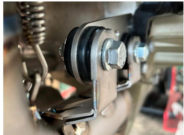
**6.Montare le staffe al telaio utilizzando le viti in dotazione, poi montare il raccordo 2 in 1 in 2**
