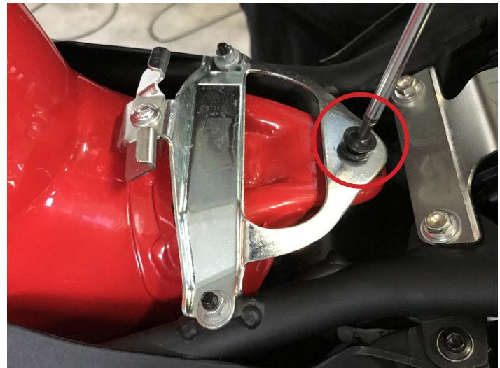
**6. Montare i collettori alle bocchette assicurandosi che ci sia la guarnizione e avvitare i bulloni.**
