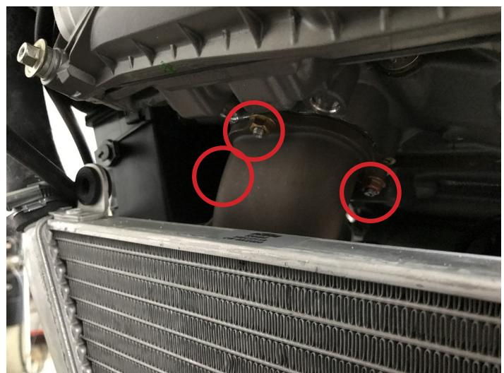
**5. Rimuovere il paracalore svitando il bullone posizionato sotto la seduta e smontare la staffa serbatoio.**
