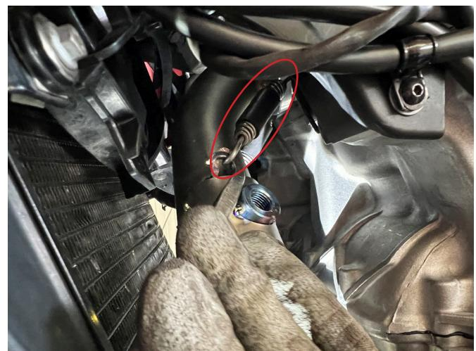
**3. Installare il raccordo 2 in 1 e fissare la staffa utilizzando la vite originale, successivamente agganciare le molle.**
