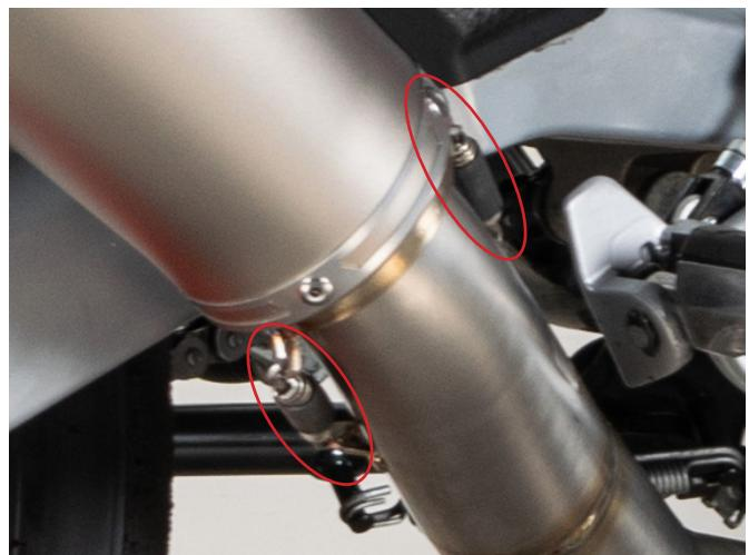
**5. Installare la staffa telaio utilizzando le viti in dotazione e fissare la staffa silenziatore utilizzando i distanziatori come in foto.**
