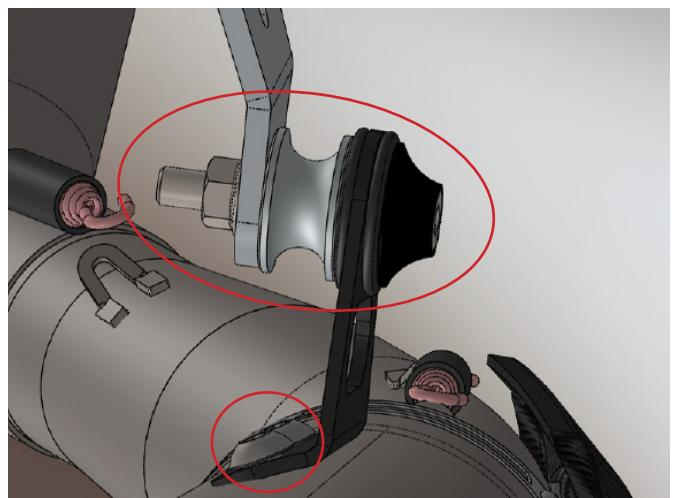
**6. Installare le mollette per le viti del paracalore e successivamente fissare il carter in carbonio sul raccordo e fissarlo con le viti in dotazione.**
