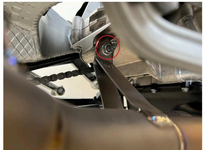
**4. Installare il raccordo silenziatore ed il silenziatore e fissare le molle.**
