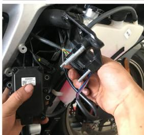
Scollegare il connettore elettrico dell'attuatore della valvola.
