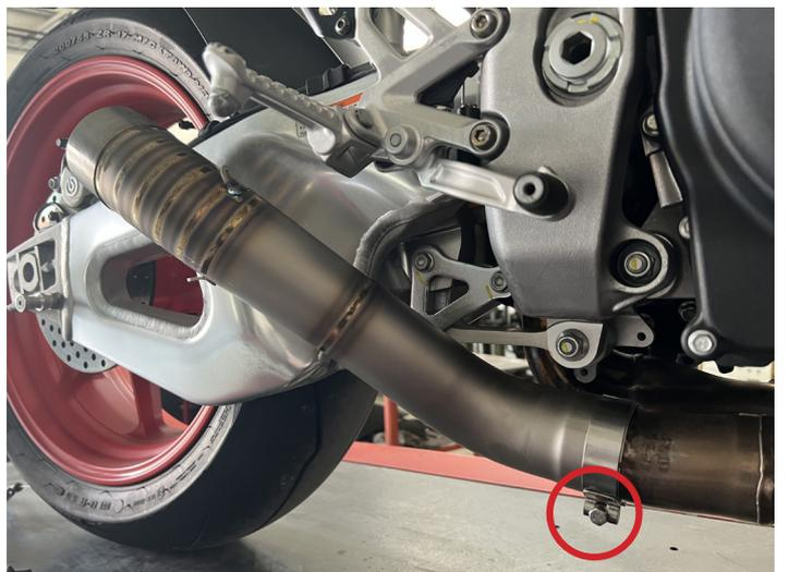
**7. Posizionare il silenziatore, montare il distanziale ed avvitare la vite sulla staffa.**
