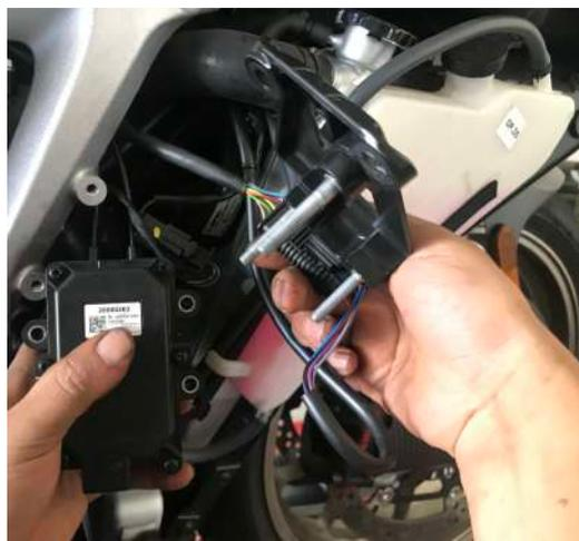
Scollegare il connettore elettrico dell'attuatore della valvola
