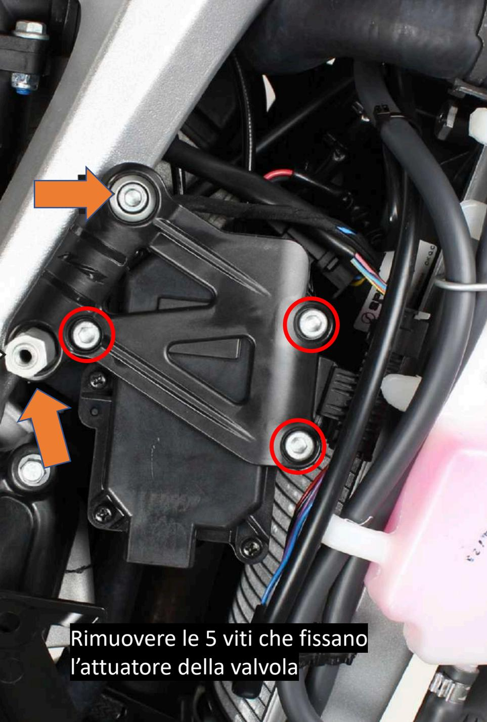
Rimuovere le 5 viti che fissano l'attuatore della valvola
